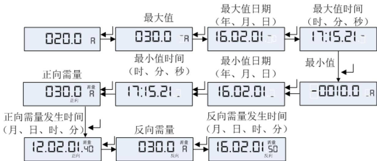
仪表上电后在电流显示界面，按左右键切换到②电压显示界面后，按回车键切换显示：电压最大值→电压最大
