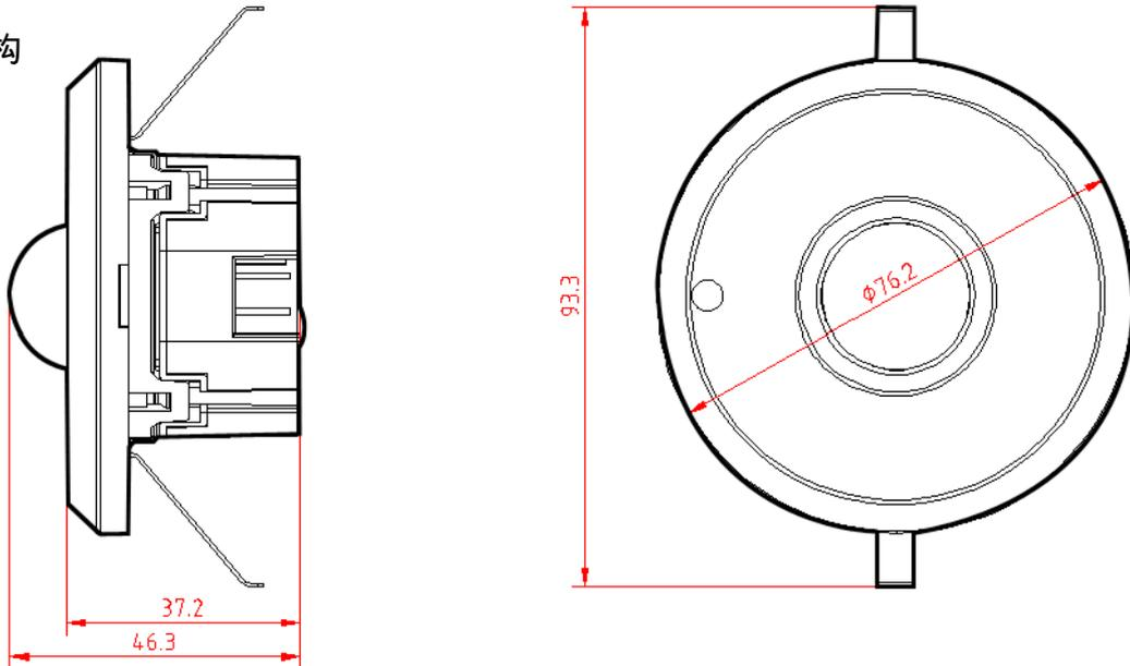
安装提示：本产品便于安装，采用嵌入式安装方式，通过使用产品左右两侧的弹簧片进行固定。该传感器安装孔尺寸大小  $58\text{mm} \pm 3\text{mm}$ ，安装过程中必须保证产品的操作、安装、测试以及维修正确。
