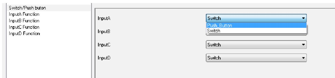
本参数用来设置所有通道的按键模式，其选项如上图有 Push Button 和 Switch 两个选项。Push Button 模式下按下按键对应 LED 点亮，松开按键对应 LED 熄灭；Switch 模式短按按键 LED 亮灭交替。
